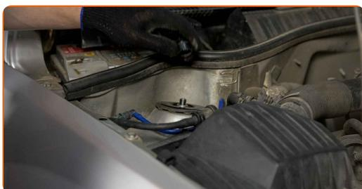
**18** Reinigen Sie die Befestigungselemente der oberen Federbeinhalterung. Benutzen Sie eine Drahtbürste. Benutzen Sie WD-40-Spray.
