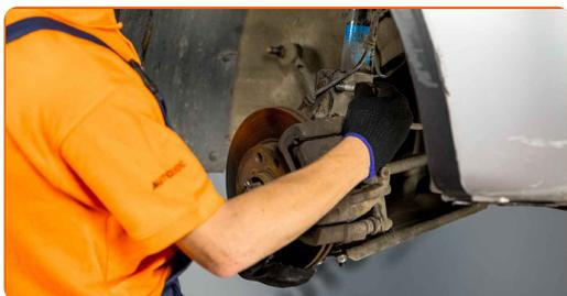
**38** Ziehen Sie die unteren Befestigungen an, die das Federbein mit dem Achsschenkel verbinden. Verwenden Sie Ring-Gabelschlüssel Nr. 18. Verwenden Sie Stecknuss Nr. 18. Verwenden Sie einen Drehmomentschlüssel. Ziehen Sie ihn mit 80 Nm Drehmoment fest.+75°
