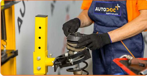
**27** Ziehen Sie die Federbeinkolbenstangenmutter an. Verwenden Sie Inbusschlüssel Nr. H6. Verwenden Sie Ring-Gabelschlüssel Nr. 19. Verwenden Sie einen Drehmomentschlüssel. Ziehen Sie ihn mit 55 Nm Drehmoment fest.
