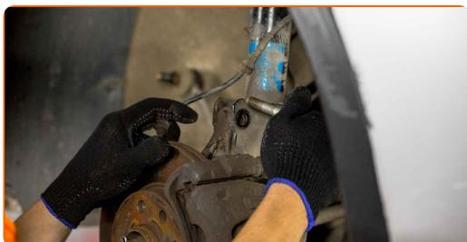
**13** Lösen Sie den unteren Bereich des Federbeins.
