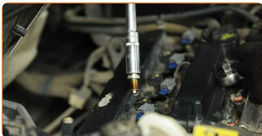
**9** Tragen Sie eine dünne Schicht eines speziellen Hochtemperatur-Anti-Seize-Schmiermittels auf das Gewinde der neuen Zündkerzen auf.
