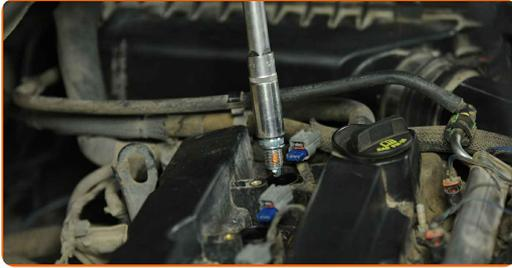
**11** Schrauben Sie die neuen Zündkerzen an und ziehen Sie diese fest. Verwenden Sie die Zündkerzennuss # 16. Verwenden Sie einen Drehmomentschlüssel. Ziehen Sie ihn mit 27 Nm Drehmoment fest.
