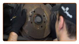
Ziehen Sie die Halteklammern der Bremstrommeln an. Verwenden Sie den Torx T30. Verwenden Sie einen Drehmomentschlüssel. Ziehen Sie ihn mit 10 Nm Drehmoment fest.
