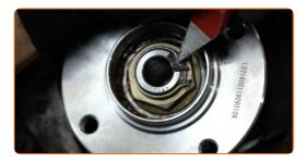
Tragen Sie ein spezielles Schmiermittel auf den Montageort für die Nabenlagerung ein. Benutzen Sie ein Kupferschmiermittel.
