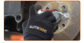
Schrauben Sie die Bremstrommel-Befestigung ab. Verwenden Sie den Torx T30. Verwenden Sie einen Schlagschrauber. Benutzen Sie einen Hammer.
