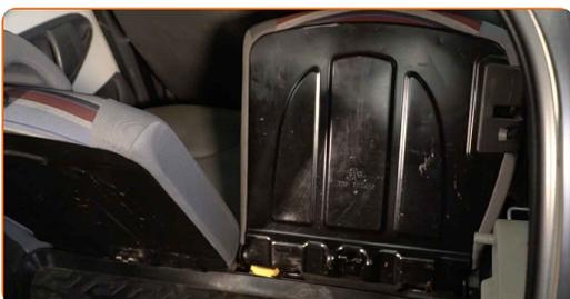
**4** Entfernen Sie die Clips der Seitenauskleidung des Kofferraums. Verwenden Sie einen Lösehebel, um die Clips zu entfernen.
