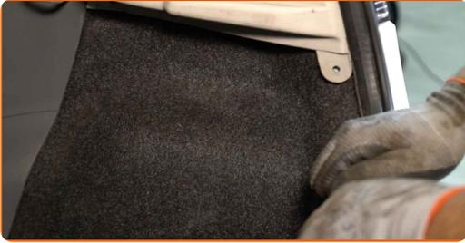
**38** Bringen Sie die Clips der Seitenauskleidung des Kofferraums an.
