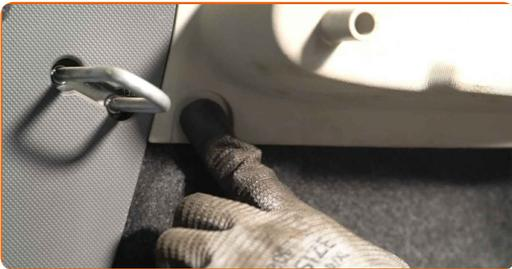
**39** Schrauben Sie das Befestigungselement der Seitenauskleidung des Kofferraums ein. Verwenden Sie einen Kreuzschlitzschraubendreher.
