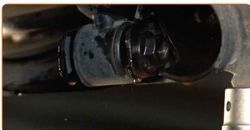
**18** Den Stoßdämpfer entfernen.
