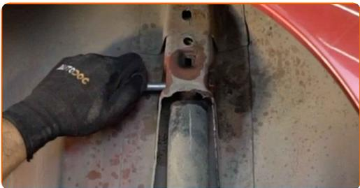
**16** Den Stoßdämpfer entfernen.
