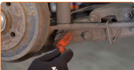
**7** Lockern Sie die untere Befestigung des Stoßdämpfers. Verwenden Sie Stecknuss Nr. 21. Verwenden Sie ein Windeisen.
