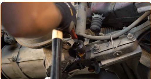
**15** Entfernen Sie die Befestigungsschraube. Verwenden Sie einen flachen Metallmeißel. Benutzen Sie einen Hammer.
