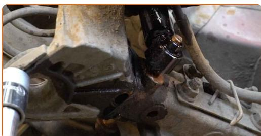
**22** Schrauben Sie das obere Befestigungselement des Stoßdämpfers ein. Verwenden Sie Stecknuss Nr. 16.
