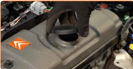
**4** Schrauben Sie den Filtergehäusedeckel zusammen mit dem alten Filterelement ab. Verwenden Sie Stecknuss Nr. 27. Verwenden Sie einen Ratschenschlüssel.
