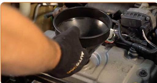
**23** Füllen Sie neues Öl in der vom Fahrzeughersteller empfohlenen Menge in den Motor ein.
