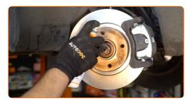
Die Bremsscheibenoberfläche reinigen. Benutzen Sie einen Bremsenreiniger.
