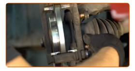
Befestigen Sie die Bremssattelhalterung. Verwenden Sie den Torx T55. Verwenden Sie einen Drehmomentschlüssel. Ziehen Sie ihn mit 105 Nm Drehmoment fest.
