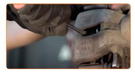
10 Entfernen Sie den Bremssattel.
