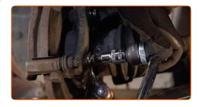
14 Entfernen Sie die Sattelhalterung.
