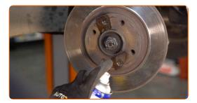
Lösen Sie die Befestigung der Bremsscheibe. Verwenden Sie den Torx T30. Verwenden Sie einen Schlagschrauber.
