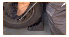
Entfernen Sie den Wagenheber sowie die Unterlegkeile.
