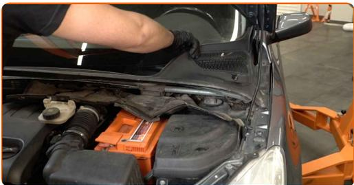
**10** Reinigen Sie die Befestigungselemente der oberen Federbeinhalterung. Benutzen Sie eine Drahtbürste. Benutzen Sie WD-40-Spray.
