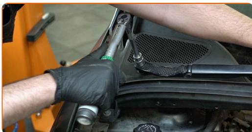
**80** Entfernen Sie die Kotflügel-Abdeckung.
