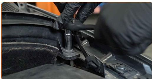
**9** Heben Sie die Windabweiserabdeckung an und entfernen Sie dieses.
