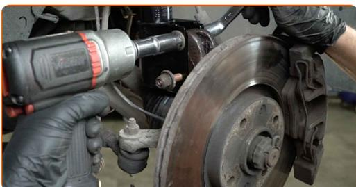
**56** Reinigen Sie die Montagesitze der Koppelstange. Benutzen Sie eine Drahtbürste. Benutzen Sie WD-40-Spray.
