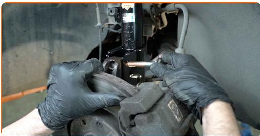
**54** Entfernen Sie den Träger unter dem Achsschenkel.
