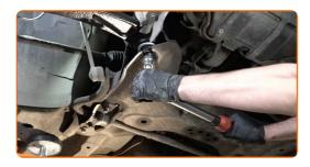
Schrauben Sie die hinteren Befestigungen, welche den Querlenker mit dem Karosseriehilfsrahmen verbinden, fest. Verwenden Sie Stecknuss Nr. 21. Verwenden Sie einen Drehmomentschlüssel. Ziehen Sie ihn mit 111 Nm Drehmoment fest.
