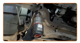
Entfernen Sie die vordere Befestigung des Querlenkers. Verwenden Sie einen Splintentreiber. Benutzen Sie einen Hammer.
