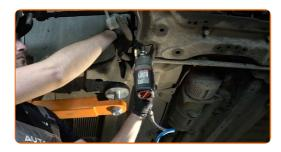
Lösen Sie die hintere Befestigung des Querlenkers.
