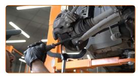
Entfernen Sie den Träger unter dem Achsschenkel.
