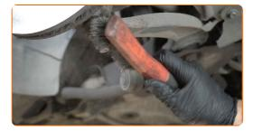
Lösen Sie das Befestigungselement, welches das Kugelgelenk am Federungsquerlenker befestigt. Verwenden Sie Stecknuss Nr. 21. Verwenden Sie ein Windeisen.
