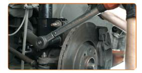
Die Antriebswellenmutter festziehen. Verwenden Sie Stecknuss Nr. 36. Verwenden Sie einen Drehmomentschlüssel. Ziehen Sie ihn mit 280 Nm Drehmoment fest.
