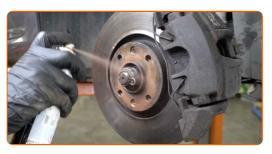
Die Bremsscheibenoberfläche reinigen. Benutzen Sie einen Bremsenreiniger.
