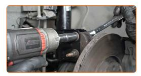
Ziehen Sie die unteren Befestigungen an, die das Federbein mit dem Achsschenkel verbinden. Verwenden Sie Ring-Gabelschlüssel Nr. 18. Verwenden Sie Stecknuss Nr. 18. Verwenden Sie einen Drehmomentschlüssel. Ziehen Sie ihn mit 90 Nm Drehmoment fest.
