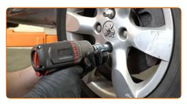
Senken Sie das Auto und ziehen Sie die Radschrauben über Kreuz an. Verwenden Sie eine Schlagnuss für Felgen # 17. Verwenden Sie einen Drehmomentschlüssel. Ziehen Sie ihn mit 100 Nm Drehmoment fest.
