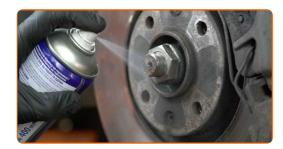
Drehen Sie das Befestigungselement der Antriebswelle auf. Verwenden Sie Stecknuss Nr. 36. Verwenden Sie einen Ratschenschlüssel.
