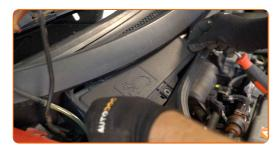
Schrauben Sie die Verbindungselemente der Innenfilter-Gehäuseabdeckung ein. Verwenden Sie einen Kreuzschlitzschraubendreher.
