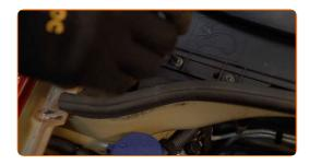
Entfernen Sie den Gehäusedeckel des Innenraumfilters.
