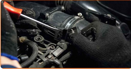
**19** Ziehen Sie die Klemme am Luftansaugschlauch fest. Verwenden Sie einen flachen Schraubendreher.
