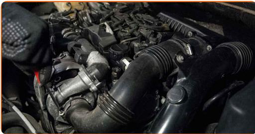
**20** Schrauben Sie die Befestigungsklemme ein, die das Luftkanal-Gehäuse mit dem Luftfilter-Gehäuse verbindet. Verwenden Sie einen flachen Schraubendreher.
