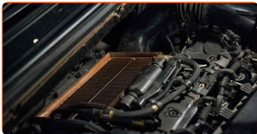
**11** Entfernen Sie das Filterelement aus dem Filtergehäuse.
