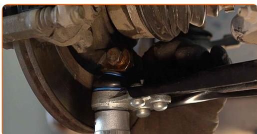
**28** Schrauben Sie das Befestigungselement ein, das das Kugelgelenk mit dem Achsschenkel verbindet. Verwenden Sie Stecknuss Nr. 16. Verwenden Sie Stecknuss Nr. E8. Verwenden Sie einen Ratschenschlüssel.
