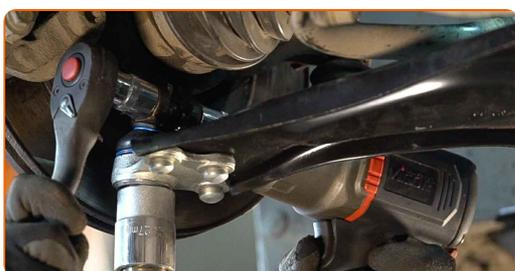
**29** Schrauben Sie die hintere Armbefestigung an. Verwenden Sie Stecknuss Nr. 18.
