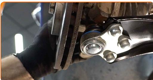
**26** Stützen Sie den Arm. Benutzen Sie einen hydraulischen Getriebeheber.
