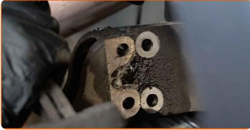
**30** Verbinden Sie das Kugelgelenk mit dem Lenker.
