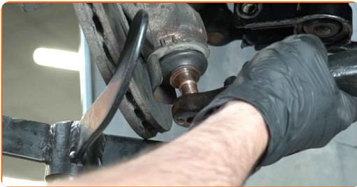
**31** Entfernen Sie den Träger unter dem Achsschenkel.
