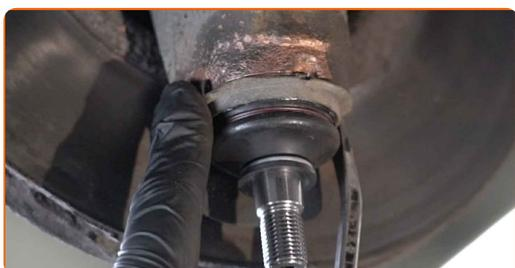
**26** Schrauben Sie das untere Befestigungselement ab, dass das Federbein mit dem Achsschenkel verbindet. Verwenden Sie Ring-Gabelschlüssel Nr. 18. Verwenden Sie Stecknuss Nr. 18. Verwenden Sie einen Ratschenschlüssel.
