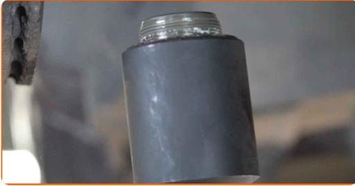
**21** Reinigen Sie den Kugelgelenk-Montagesitz. Benutzen Sie eine Drahtbürste. Benutzen Sie WD-40-Spray.
