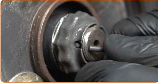
**38** Schrauben Sie die Befestigungen des Kugelgelenks ein. Verwenden Sie Stecknuss Nr. 21. Verwenden Sie einen Ratschenschlüssel.
