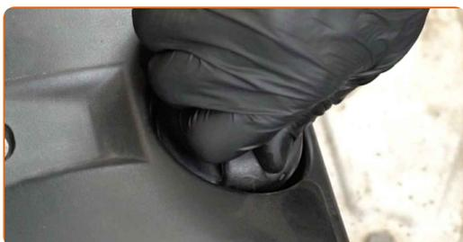
**29** Befestigen Sie den Deckel des Öleinfüllstutzens.
