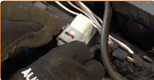
**28** Verbinden Sie den Schlauch der Kurbelgehäuseentlüftung mit dem Lüftungsrohr.
