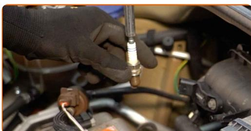
**16** Tragen Sie eine dünne Schicht eines speziellen Hochtemperatur-Anti-Seize-Schmiermittels auf das Gewinde der neuen Zündkerzen auf.
