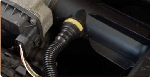
**27** Montieren Sie die Kurbelgehäuse-Entlüftungsschläuche.
