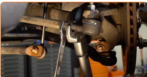
**19** Behandeln Sie das Befestigungselement, das den Spurstangenkopf mit dem Achsschenkel verbindet. Benutzen Sie ein Kupferschmiermittel.
