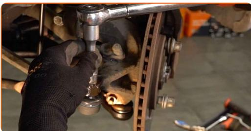
**18** Ziehen Sie die Spurstangenkopf Sicherungsmutter an. Verwenden Sie Ring-Gabelschlüssel Nr. 19 (2 Teile). Verwenden Sie einen Drehmomentschlüssel. Ziehen Sie ihn mit 62 Nm Drehmoment fest.
