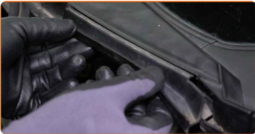
**32** Bauen Sie die Dichtung der Windabweiserabdeckung ein.
