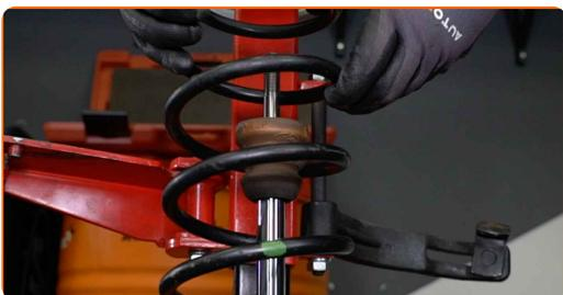
**30** Installieren Sie die Staubschutzmanschette und den Anschlagpuffer auf dem neuen Stoßdämpfer.
