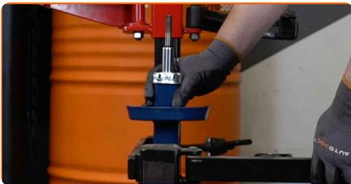
**29** Installieren Sie die Feder am Stoßdämpfer.
