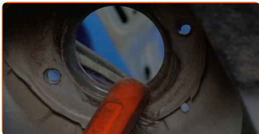
**38** Installieren Sie das Federbein am Radlauf.
