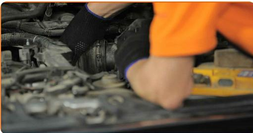
**20** Ziehen Sie die Klemme am Luftansaugschlauch fest. Verwenden Sie Stecknuss Nr. 5.5. Verwenden Sie einen Ratschenschlüssel.
