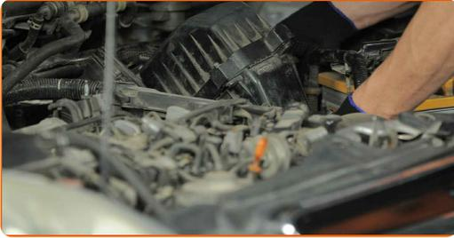
**18** Schrauben Sie die Filtergehäuse-Befestigungsbolzen an. Verwenden Sie Stecknuss Nr. 10. Verwenden Sie einen Ratschenschlüssel.
