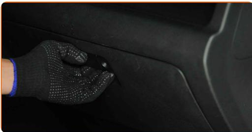
**3** Lösen Sie das Sperrkabel (Kabelband) vom Handschuhfachdeckel. Verwenden Sie einen flachen Schraubendreher.
