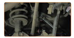
Installieren Sie die Stabbefestigung am Stabilisator und ziehen Sie diese an. Verwenden Sie Ring-Gabelschlüssel Nr. 17. Verwenden Sie Stecknuss Nr. 17. Verwenden Sie Inbusschlüssel Nr. H6. Verwenden Sie einen Drehmomentschlüssel. Ziehen Sie ihn mit 38 Nm Drehmoment fest.
