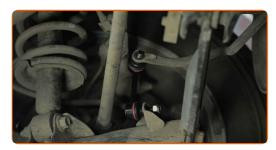
Ziehen Sie das Befestigungselement an, das die Druckstange mit dem Stabilisator verbindet. Verwenden Sie Ring-Gabelschlüssel Nr. 17. Verwenden Sie Inbusschlüssel Nr. H6. Verwenden Sie einen Drehmomentschlüssel. Ziehen Sie ihn mit 38 Nm Drehmoment fest.
