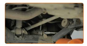
Schrauben Sie das Befestigungselement heraus, das die Druckstange mit dem Stabilisator verbindet. Verwenden Sie Ring-Gabelschlüssel Nr. 14. Verwenden Sie Stecknuss Nr. 14. Verwenden Sie einen Ratschenschlüssel.
