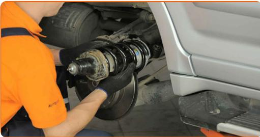
**31** Schrauben Sie die obere Befestigung des Federbeinbefestigung an.
