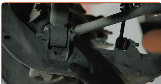
**7** Untere Befestigung der Stoßdämpferfedern abschrauben. Verwenden Sie Stecknuss Nr. 17. Verwenden Sie ein Windeisen. Verwenden Sie einen Ratschenschlüssel.
