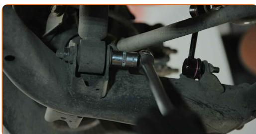
**8** Entfernen Sie die Befestigungsschraube. Benutzen Sie ein Brecheisen.
