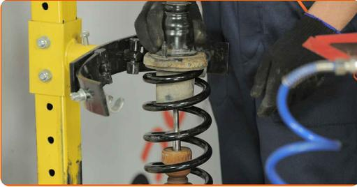
**30** Installieren Sie das Federbein am Radlauf.
