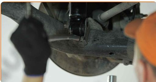
**38** Bringen Sie die Befestigungsschraube an. Benutzen Sie ein Brecheisen. Verwenden Sie Stecknuss Nr. 17. Verwenden Sie einen Ratschenschlüssel.
