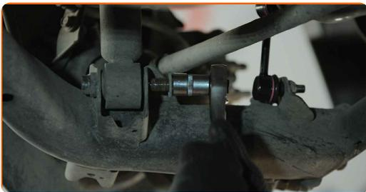
**9** Lösen Sie den unteren Bereich des Federbeins. Benutzen Sie ein Brecheisen.
