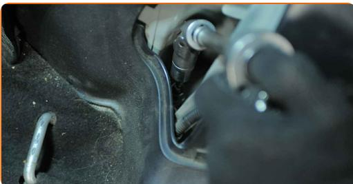
**33** Behandeln Sie die Befestigungselemente des Federbeinstützlagers. Benutzen Sie ein Kupferschmiermittel.
