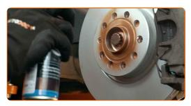
Die Bremsscheibenoberfläche reinigen. Benutzen Sie einen Bremsenreiniger.
