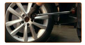
Entfernen Sie den Wagenheber sowie die Unterlegkeile.
