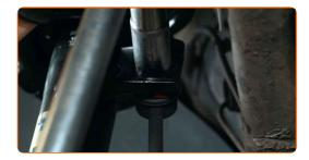
Ziehen Sie das Befestigungselement an, das die Druckstange mit dem Stabilisator verbindet. Verwenden Sie Ring-Gabelschlüssel Nr. 18. Verwenden Sie Stecknuss Nr. 18. Benutzen Sie den XZN #6. Verwenden Sie einen Drehmomentschlüssel. Ziehen Sie ihn mit 55 Nm Drehmoment fest.
