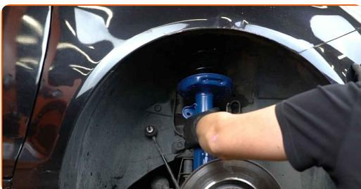
**46** Schrauben Sie die obere Befestigung des Federbeinbefestigung an Schrauben Sie diese nicht fest.
