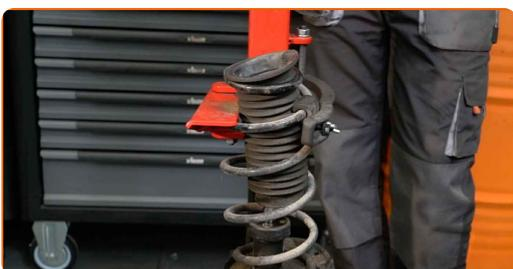
**35** Die Staubkappe des Stoßdämpfers und den Anschlagpuffer entfernen.
