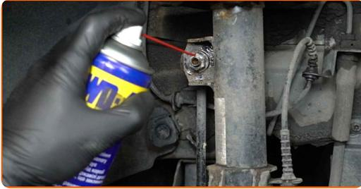
**17** Schrauben Sie das Befestigungselement heraus, das die Druckstange mit dem Federbein verbindet. Verwenden Sie Ring-Gabelschlüssel Nr. 15. Verwenden Sie den Torx T30. Verwenden Sie einen Ratschenschlüssel.
