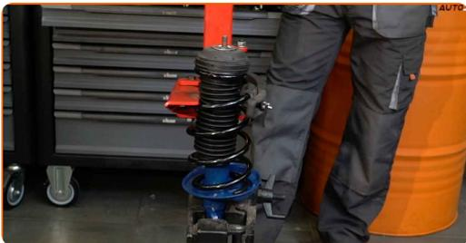
**43** Entfernen Sie das zusammengebaute Federbein.
