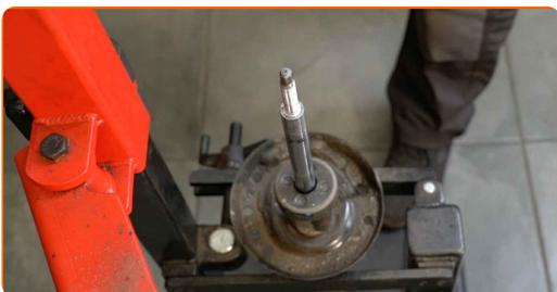
**37** Installieren Sie die Feder am Stoßdämpfer.
