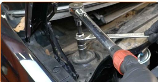
**66** Behandeln Sie die Befestigungselemente des Federbeinstützlagers. Benutzen Sie ein Kupferschmiermittel.
