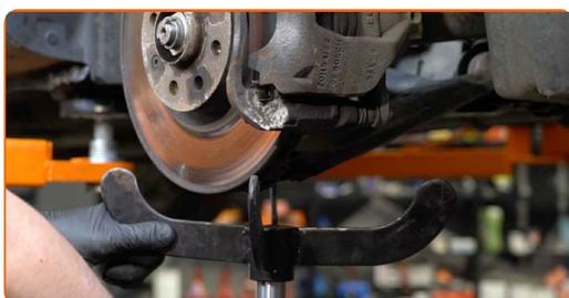
**25** Entfernen Sie die Befestigungsschrauben.
