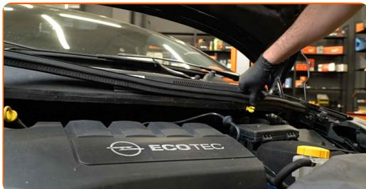
**72** Entfernen Sie die Kotflügel-Abdeckung.
