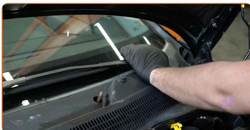
**69** Ziehen Sie die Befestigungen der Wischerarme fest. Verwenden Sie Stecknuss Nr. 13. Verwenden Sie einen Drehmomentschlüssel. Ziehen Sie ihn mit 21 Nm Drehmoment fest.
