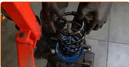
**38** Installieren Sie die Manschette und eine Stoßstopp auf den Stoßdämpfer.
