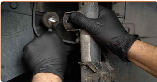
**19** Behandeln Sie die Halteklammer des Bremsschlauchs.
