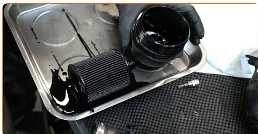
**21** Den Dichtungsring des Ölfilterdeckels entfernen. Verwenden Sie einen flachen Schraubendreher.
