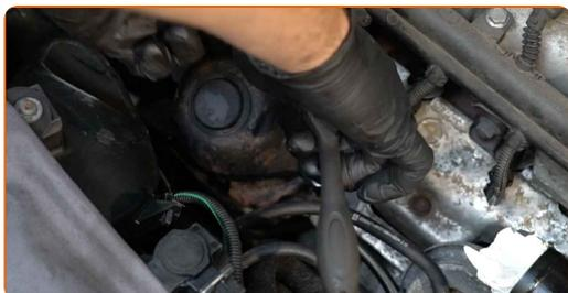
**Austausch: Motoröl und Ölfilter – Opel Corsa D. Tipp von AUTODOC-Experten:**
