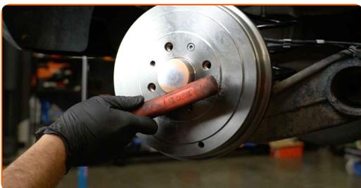
**40** Behandeln Sie die Oberfläche, an der die Radfelge die Bremstrommel berührt. Benutzen Sie ein Kupferschmiermittel.
