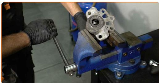
**24** Reinigen Sie die Stoßdämpferaufnahmen. Benutzen Sie eine Drahtbürste. Benutzen Sie WD-40-Spray.
