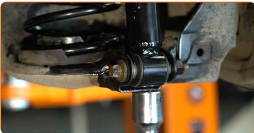
**25** Ziehen Sie den unteren Befestiger des Stoßdämpfers an. Verwenden Sie Stecknuss Nr. E18. Verwenden Sie einen Drehmomentschlüssel. Ziehen Sie ihn mit 90 Nm Drehmoment fest.
