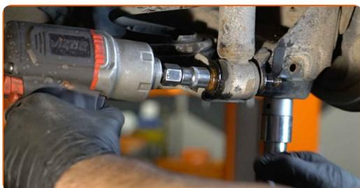
**15** Entfernen Sie die Befestigungsschraube.
