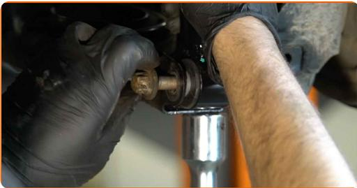
**23** Schrauben Sie das untere Befestigungselement des Stoßdämpfers ein. Verwenden Sie Stecknuss Nr. E18. Verwenden Sie einen Ratschenschlüssel.
