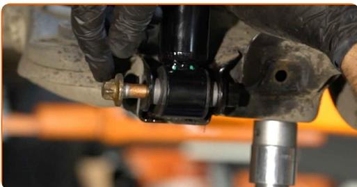
29 Schrauben Sie das untere Befestigungselement des Stoßdämpfers ein. Verwenden Sie Stecknuss Nr. E18. Verwenden Sie einen Ratschenschlüssel.
