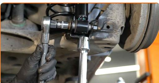
26 Die Montage unter dem Hinterachsträger entfernen.
