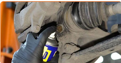
**11** Schrauben Sie die Befestigungen des Bremssattelhalters ab. Verwenden Sie Stecknuss Nr. 18. Verwenden Sie ein Windeisen. Verwenden Sie einen Ratschenschlüssel.
