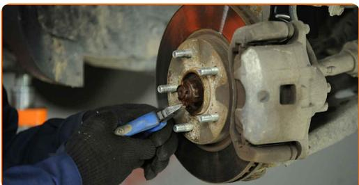
**7** Reinigen Sie das Befestigungselement der Antriebswelle. Benutzen Sie eine Drahtbürste. Benutzen Sie WD-40-Spray.
