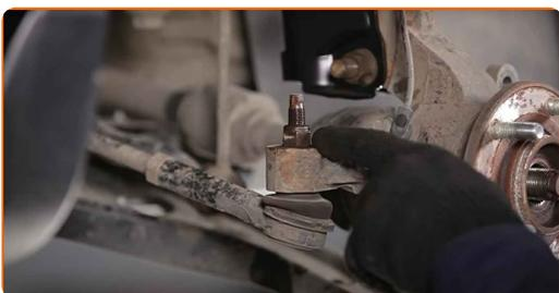
**17** Lösen Sie das Ende der Befestigungsmutter an dem Achsschenkel. Verwenden Sie Ring-Gabelschlüssel Nr. 18. Verwenden Sie einen Ratschenschlüssel.
