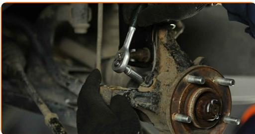
**58** Bauen Sie den Spurstangenkopf an dem Achsschenkel an.
