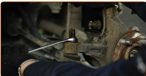
**18** Ziehen Sie den Spurstangenkopf vom Achsschenkel. Verwenden Sie einen Kugelgelenkabzieher.
