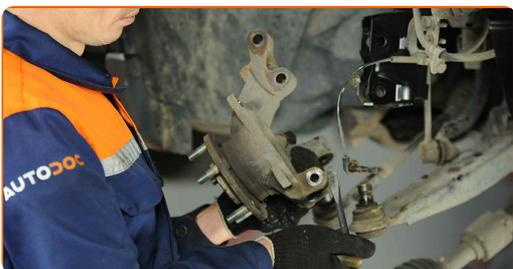
**32** Entfernen Sie die Radnabe vom Achsschenkel. Verwenden Sie einen Druckstücksatz mit Ein-/Auspresswerkzeug. Benutzen Sie einen Hammer.
