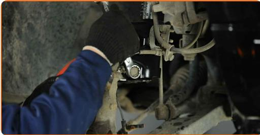
**46** Behandeln Sie die Keilwellen des Antriebswellen-Gleichlaufgelenks. Benutzen Sie eine Drahtbürste. Benutzen Sie WD-40-Spray.
