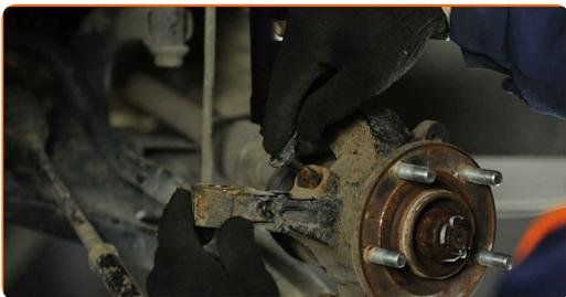
**57.2** Verwenden Sie Stecknuss Nr. 10. Verwenden Sie einen Ratschenschlüssel.
