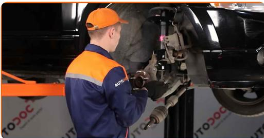
**31** Entfernen Sie die Achsschenkel zusammen mit der Nabe.
