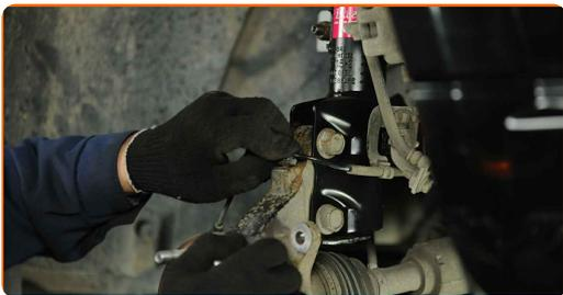
**57.1** Bauen Sie den ABS-Sensor auf dem Achsschenkel ein und sichern Sie ersteren.
