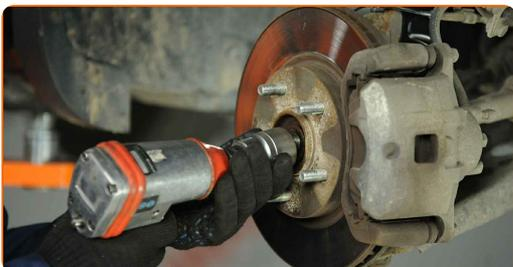
**9** Entfernen Sie die Befestigungsmutter.
