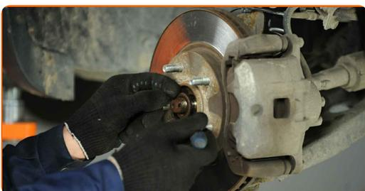
**10** Die Befestigungselemente der Bremssattelhalterung reinigen. Benutzen Sie eine Drahtbürste. Benutzen Sie WD-40-Spray.
