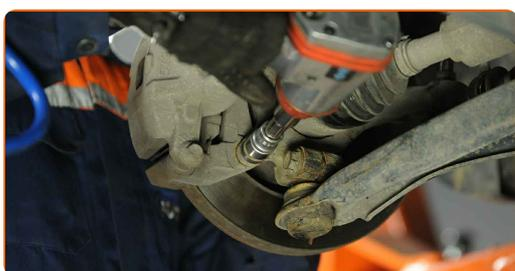
**65** Behandeln Sie das Befestigungselement, das den Spurstangenkopf mit dem Achsschenkel verbindet. Behandeln Sie die Befestigungen des Achsschenkels. Natrite upevňovacie prvky držiaka brzdového strmeňa. Behandeln Sie die Befestigungen, die den Querlenker mit dem Achsschenkel verbinden. Benutzen Sie ein Kupferschmiermittel.
