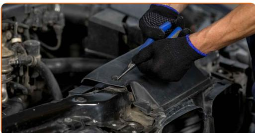
**4** Trennen Sie das Luftkanal-Gehäuse vom Luftfilter-Gehäuse.
