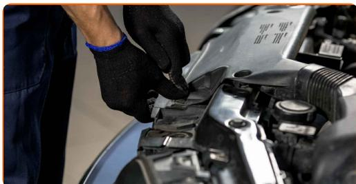
**14** Entfernen Sie die Kotflügel-Abdeckung.
