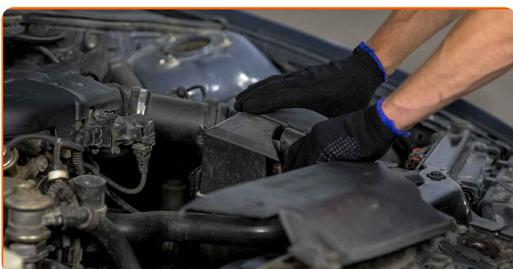
**5** Schieben Sie die Klammern des Filtergehäuses ab.
