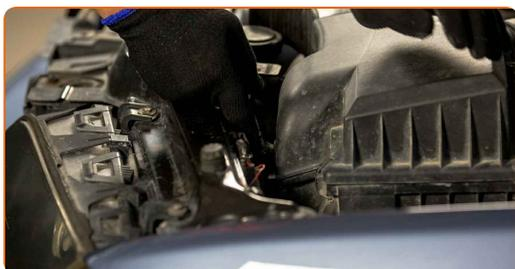
**12** Bringen Sie das Luftkanal-Gehäuse an.
