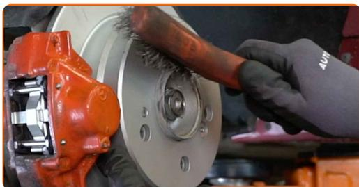
**50** Behandeln Sie die Oberfläche, an der die Bremsscheibe die Felge berührt. Verwenden Sie Keramikfett.
