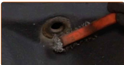
**18** Reinigen Sie die Befestigungen des Querlenkers. Benutzen Sie eine Drahtbürste. Benutzen Sie WD-40-Spray.
