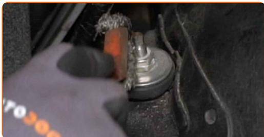
**4** Lockern Sie das obere Befestigungsgelelement des Stoßdämpfers. Verwenden Sie Ring-Gabelschlüssel Nr. 17. Verwenden Sie einen Stoßdämpfer Steckschlüsseleinsatz Nr. DD5.2. Verwenden Sie einen Ratschenschlüssel.
