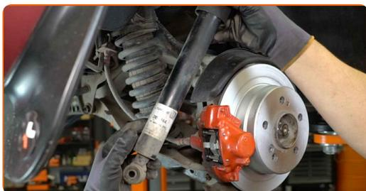
**17** Reinigen Sie die Stoßdämpferaufnahmen. Benutzen Sie eine Drahtbürste. Verwenden Sie Allzweckreinigungsspray.
