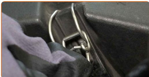
**12** Entfernen Sie die Kotflügel-Abdeckung.
