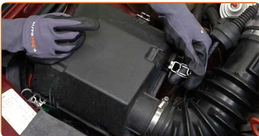
**4** Entfernen Sie die Abdeckung des Luftfilters.
