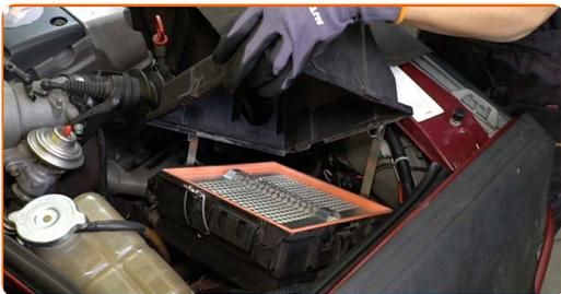
**5** Bedecken Sie den Luftansaugschlauch mit einem Mikrofaser Tuch, um zu vermeiden, dass Staub und Schmutz in das System gelangen.
