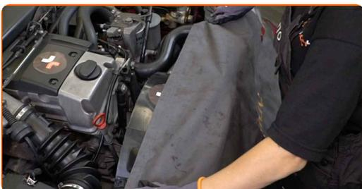
**3** Lösen Sie die Befestigungsclips der Luftfilterabdeckung.
