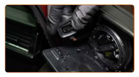
Behandeln Sie den Stecker der Spiegelheizung mit einem Kontaktspray. Verwenden Sie dielektrisches Fett.
