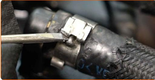
**19** Ziehen Sie den Kraftstoffschlauch vom Kraftstofffilter ab.
