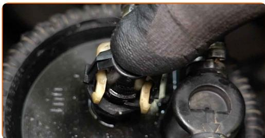
**17** Sichern Sie die Kraftstofffilterleitung mit der Halteklammer.
