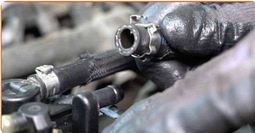
**20** Entlüften Sie die Kraftstoffanlage manuell. Verwenden Sie einen Kraftstoffpumpball.
