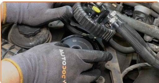
**14** Setzen Sie den Deckel des Kraftstofffiltergehäuses auf und ziehen Sie ihn fest.
