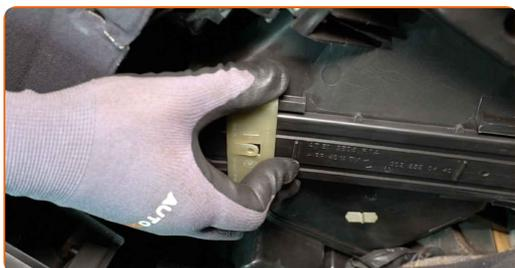
**6** Entfernen Sie die Abdeckung des Innenraumfilters.
