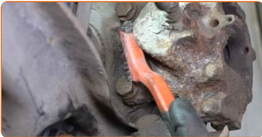
**14** Schrauben Sie die Befestigungen des Bremssattels ab. Verwenden Sie Stecknuss Nr. 16. Verwenden Sie einen Ratschenschlüssel.
