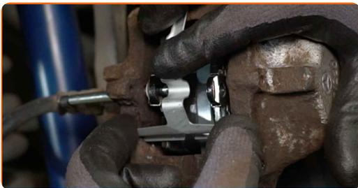
**36** Montieren Sie den Bremsbelagbolzen. Verwenden Sie einen Splintentreiber. Benutzen Sie einen Hammer.
