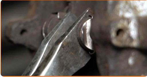
**12** Entfernen Sie die Bremsbeläge.
