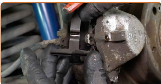
**11** Verteilen Sie die Bremsbeläge. Benutzen Sie ein Brecheisen.
