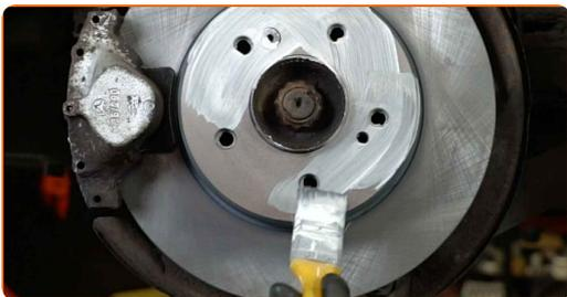
**38** Die Bremsscheibenoberfläche reinigen. Benutzen Sie einen Bremsenreiniger.
