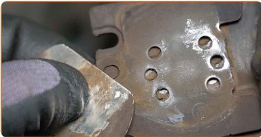
**13** Die Bremssattelbefestigungen reinigen. Benutzen Sie eine Drahtbürste. Benutzen Sie WD-40-Spray.
