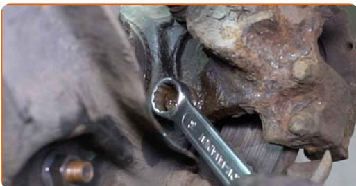
**15** Entfernen Sie die Befestigungsschrauben.
