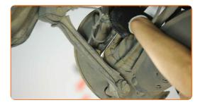
Verbinden Sie das ABS mit der Sensorverdrahtung.
