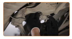
Lösen Sie die Verkabelung des ABS-Sensors vom Querlenker der Aufhängung.
