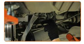
18 Installieren Sie das hintere Befestigungselement des Querlenkers.
