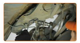
Entfernen Sie den Träger unter dem Arm.
