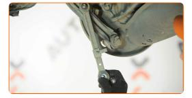
Reinigen Sie das Befestigungselement der ABS-Sensor-Halterung. Benutzen Sie eine Drahtbürste. Benutzen Sie WD-40-Spray.
