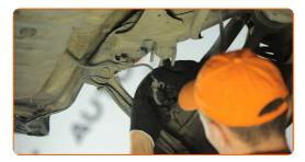
Entfernen Sie den Arm. Verwenden Sie einen Kugelgelenkabzieher.
