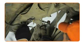
Lösen Sie die hintere Befestigung des Querlenkers. Benutzen Sie einen Hammer.
