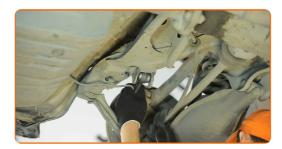
Ziehen Sie das Befestigungselement an, das den Aufhängungsarm mit dem hinteren Achsschenkel verbindet.
