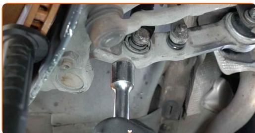
**54** Schrauben Sie das Befestigungselement ein, das den Querlenker mit dem Hilfsrahmen verbindet. Verwenden Sie Ring-Gabelschlüssel Nr. 21. Verwenden Sie Stecknuss Nr. E18. Verwenden Sie einen Ratschenschlüssel.
