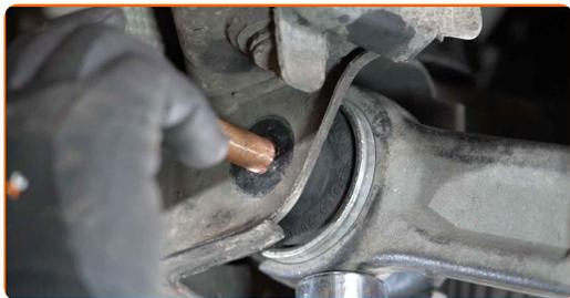
**52** Entfernen Sie den Träger unter dem Arm.
