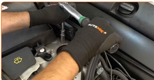
**71** Behandeln Sie die Befestigungselemente des Federbeinstützlagers. Benutzen Sie ein Kupferschmiermittel.
