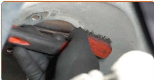
**42** Reinigen Sie die Montagebohrungen und die Gewinde des Querlenkers. Benutzen Sie eine Drahtbürste. Benutzen Sie WD-40-Spray.
