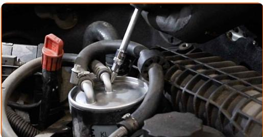
**10** Lösen Sie die Schläuche vom Kraftstofffilter. Verwenden Sie eine Rundzange.
