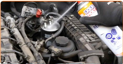
**8** Lösen Sie die Halterung des Kraftstofffilters. Verwenden Sie Inbusschlüssel Nr. H5. Verwenden Sie einen Ratschenschlüssel.
