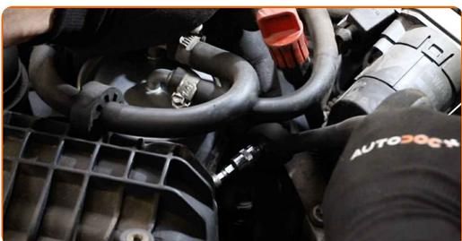
**9** Lockern Sie die Befestigungsklemme der Kraftstofffilterleitung. Verwenden Sie Stecknuss Nr. 5.5. Verwenden Sie Stecknuss Nr. 7. Verwenden Sie einen Ratschenschlüssel.
