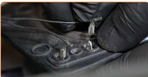
7 Behandeln Sie die Steckverbindungen der Spiegelheizung. Verwenden Sie dielektrisches Fett.
