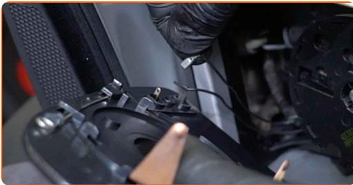
9 Bauen Sie das neue Spiegelglas ein. Stellen Sie sicher, dass Sie dabei das Klicken hören, welches entsteht, wenn sich diese in der korrekten Position befindet.
