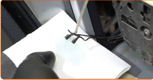
8 Schließen Sie die Steckverbindungen der Spiegelheizung wieder an.
