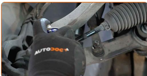
**13** Schrauben Sie einen neuen Spurstangenkopf an. Verwenden Sie Ring-Gabelschlüssel Nr. 14.
