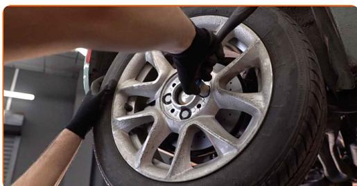
**21** Senken Sie das Auto und ziehen Sie die Radschrauben über Kreuz an. Verwenden Sie einen Drehmomentschlüssel. Ziehen Sie ihn mit 98 Nm Drehmoment fest.
