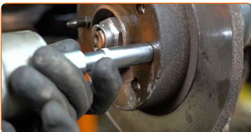
**18** Entfernen Sie die Bremsscheibe. Verwenden Sie einen Gummi-Hammer.
