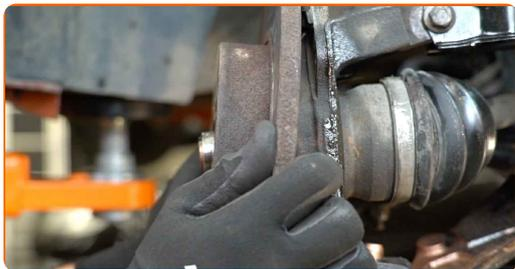
**19** Reinigen Sie die Nabe. Benutzen Sie eine Drahtbürste. Behandeln Sie die Kontaktfläche. Benutzen Sie ein Kupferschmiermittel.
