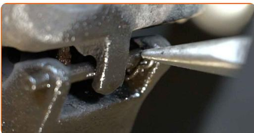
**10** Entfernen Sie den Sicherungsstift vom Bremsattel. Verwenden Sie einen Splintentreiber. Benutzen Sie einen Hammer.
