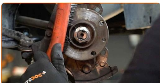
**20** Die Bremsscheibenoberfläche reinigen. Verwenden Sie Allzweckreinigungsspray.
