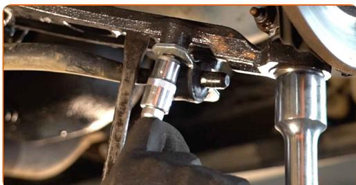
**14** Schrauben Sie das Befestigungselement ein, das den Stabilisator mit dem Querlenker verbindet. Verwenden Sie Stecknuss Nr. 13. Verwenden Sie einen Ratschenschlüssel.
