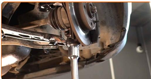
**11** Reinigen Sie die Montagesitze der Koppelstange. Benutzen Sie eine Drahtbürste. Benutzen Sie WD-40-Spray.
