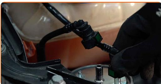
**12** Verbinden Sie das EntlüftungsKit mit der Kraftstofffilter-Entlüftungsschraube.
