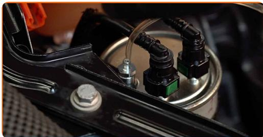
**13** Schrauben Sie die Kraftstofffilter-Entlüftungsschraube heraus. Verwenden Sie Ring-Gabelschlüssel Nr. 12.
