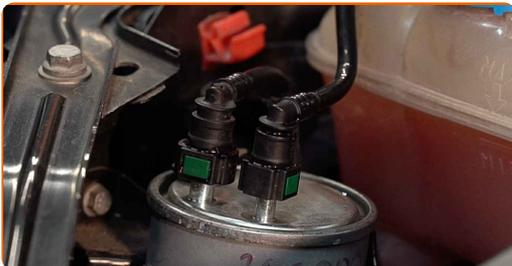
**4** Drücken Sie die Clips zusammen und lösen Sie die Kraftstoffzufuhrleitungen vom Kraftstofffiltergehäuse. Verwenden Sie Kraftstoffleitungsanzangen.
