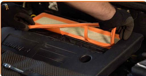
**6** Reinigen Sie die Abdeckung und das Gehäuse des Luftfilters.
