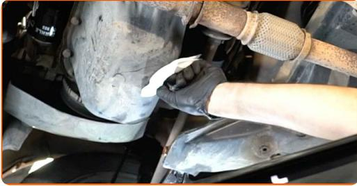
**17** Schrauben Sie die neue Ablassschraube ein und ziehen Sie sie fest. Verwenden Sie Inbusschlüssel Nr. H12. Verwenden Sie einen Drehmomentschlüssel. Ziehen Sie ihn mit 22 Nm Drehmoment fest.
