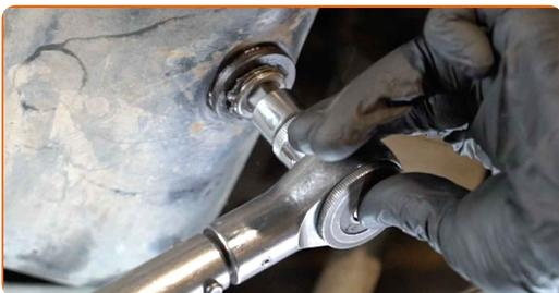
**18** Reinigen Sie den Bereich um die Ablassöffnung der Ölwanne. Verwenden Sie Allzweckreinigungsspray.
