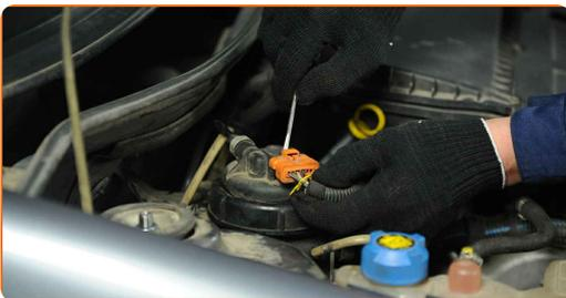
**4** Schrauben Sie die Kraftstofffilterabdeckung ab.
