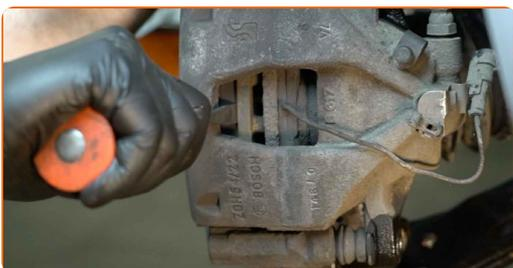
**11** Entfernen Sie den Bremssattel.
