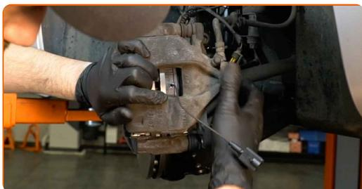
**19** Verbinden Sie den Bremsbelag-Verschleiß-Sensor.
