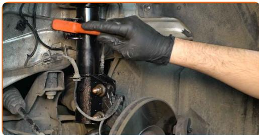
**11** Bringen Sie eine neue Stange an, ziehen Sie die Schrauben fest. Verwenden Sie Ring-Gabelschlüssel Nr. 17. Verwenden Sie Stecknuss Nr. 17. Verwenden Sie einen Ratschenschlüssel.
