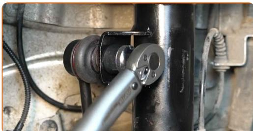
**13** Ziehen Sie das Befestigungselement an, das die Druckstange mit dem Stabilisator verbindet. Verwenden Sie Stecknuss Nr. 17. Verwenden Sie einen Drehmomentschlüssel. Ziehen Sie ihn mit 50 Nm Drehmoment fest.
