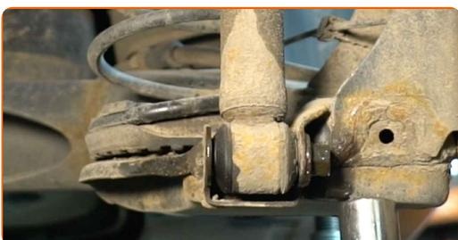
**14** Den Stoßdämpfer entfernen.
